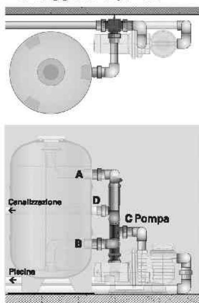
VALVOLE besgo dal DN65 / DN80 / DN100 e DN125 dovrebbero essere fissate con delle bride alla parete.
