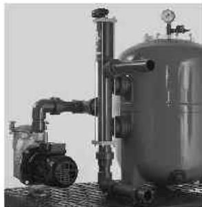
Tous les raccords vers le dispositif de contre-lavage automatique sont susceptibles d'être collés à l'extérieur (manchon adhésif). Il faudrait que la tuyauterie en direction du dispositif de contre-lavage automatique soit installée moyennant des raccords à vis ou des brides (raccordements amovibles). Un montage exempt de contrainte doit être réalisé.
