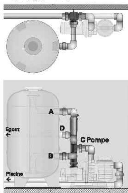
Les vannes besgo à partir de DN65 / DN80 / DN100 et DN125 devraient être montées au mur moyennant des colliers pour tuyaux (vous incombaud).
