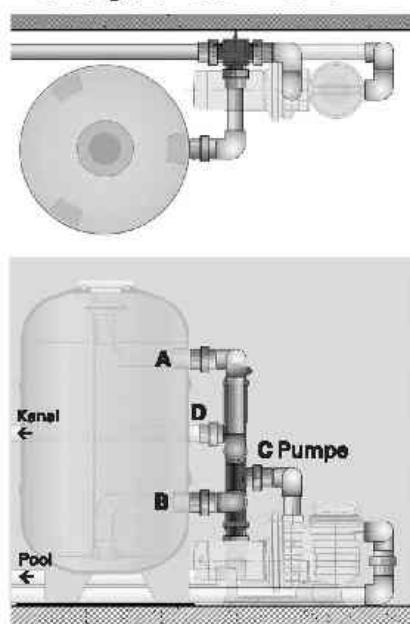
**besgo VENTILE**, ab DN65 / DN80 / DN100 und DN125 sollten mit Rohrschellen an der Wand montiert werden (bauseits).
